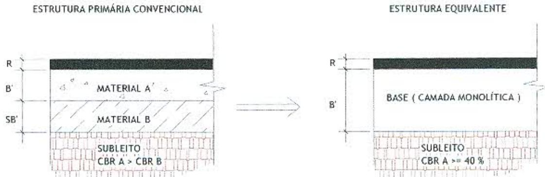
Uma vez definidos os parâmetros: número N e CBR do sub-leito pode-se dimensionar o pavimento com o auxílio do ábaco de dimensionamento e das inequações abaixo:
